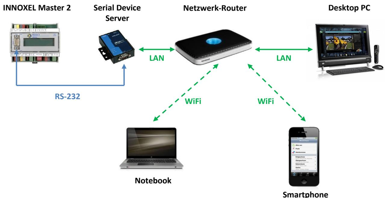
In dieser Anleitung erfahren Sie, wie Sie den Serial Device Server MOXA NPort 5110 oder MOXA NPort 5110A richtig konfigurieren, damit Sie diese Möglichkeiten nutzen können.
